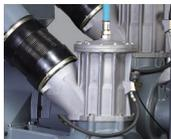
进气阀：常闭式进气阀，有效降低开机启动电流。
