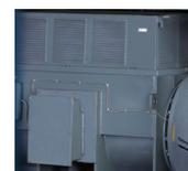
驱动电机：稳固的电机，机箱内优化的气流组织和温度场，使电机得到良好冷却。
